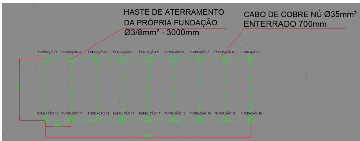
Figura 10 – Ilustração da malha de aterramento a ser instalada
